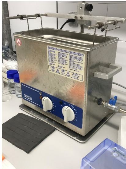
◀ Ultraschallgerät für das Homogenisieren von Lösungen
