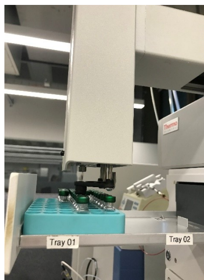
◀ Offener Autosampler eines HPLC-Geräts während der Probeninjektion
