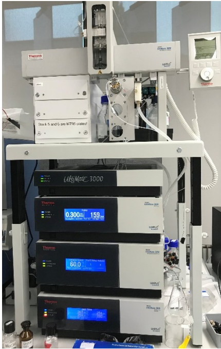
Abbildung 12: HPLC-Messgerät Thermo Scientific UltiMate 3000 (43)
